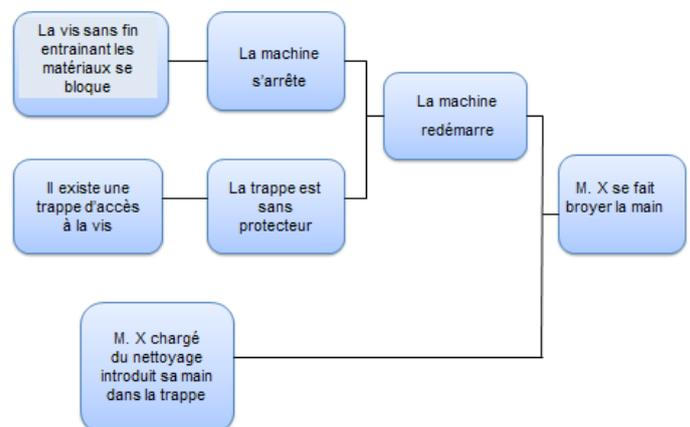
L'affaire est simple : pour éviter la répétition d'un tel accident, il n'est qu'à empêcher la réitération d'un des « événements ». Interdire, conclura-t-on qu'une main pénètre dans le trou de poing.
